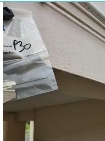
Matériaux : Z14 - Hall - Poutre - Enduit + peinture Prélèvement : P030 Description : enduit + peinture Localisation : BAT 3 - Passage hall - Poutre Résultat : Absence d'amiante
