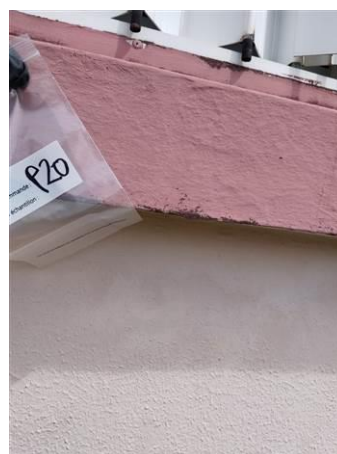
Matériaux : Z07 - Facades - Appuie fenêtre - Enduit + peinture Prélèvement : P020 Description : enduit + peinture Localisation : BAT 3 - Façade Avant Gauche - Appuie fenêtre Résultat : Absence d'amiante
