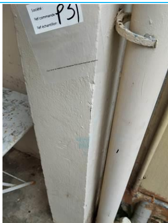
Matériaux : Z12 - Façades - Poteau - Enduit + peinture Prélèvement : P031 Description : enduit + peinture Localisation : BAT 3 - Passage hall - poteau Résultat : Absence d'amiante
