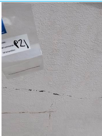
Matériaux : Z08 - Façades - Mur - Enduit + peinture Prélèvement : P021 Description : enduit + peinture Localisation : BAT 3 - Façade Avant Gauche - Mur haut Résultat : Absence d'amiante
