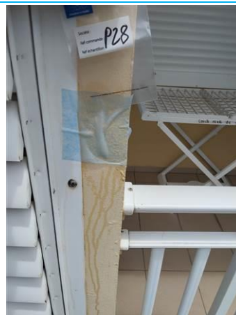
Matériaux : Z12 - Façades - Poteau - Enduit + peinture Prélèvement : P028 Description : enduit + peinture Localisation : BAT 3 - Façade Avant Gauche - poteau Résultat : Absence d'amiante
