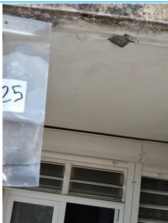
Matériaux : Z10 - Façades - Plafond de balcon - Enduit + peinture Prélèvement : P025 Description : enduit + peinture Localisation : BAT 3 - Façade Avant Gauche - Plafond balcon Résultat : Absence d'amiante
