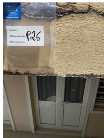
Matériaux : Z09 - Façades - Tranche - Enduit + peinture Prélèvement : P026 Description : enduit + peinture Localisation : BAT 3 - Façade Avant Gauche - Tranche horizontale Résultat : Absence d'amiante
