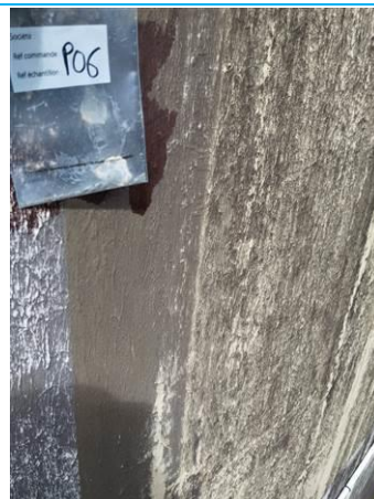
Matériaux : Z02 - Pignons - Mur milieu - enduit + peinture Prélèvement : P006 Description : enduit + peinture Localisation : BAT 3 - 2eme pignon - Mur milieu Résultat : Absence d'amiante
