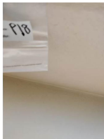
Matériaux : Z06 - Facades - Sous face casquette - Enduit + peinture Prélèvement : P018 Description : enduit + peinture Localisation : BAT 3 - Façade Avant Gauche - Sous face casquette Résultat : Absence d'amiante
